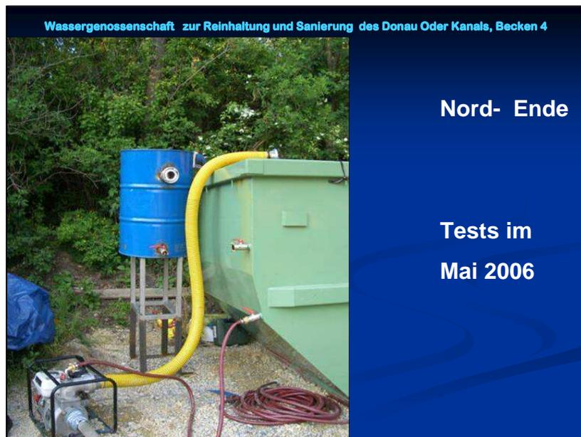
Ein Container mit einem Fassungsvermögen von 10 m<sup>3</sup> wurde aufgestellt und für unsere Zwecke adaptiert und weitere Tests durchgeführt.
